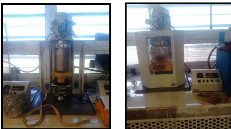
Imagen 1 Adaptación del reactor PARR Modelo 5100
