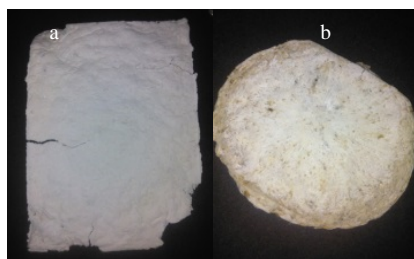
Figura 2. Espumas solidas a base de almidón (a) y mezclas de almidón con fibra de maguey (b)
