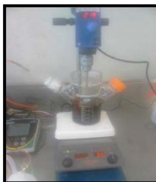
Imagen 4 Hidrolisis con el Pretratamiento de autohidrólisis.
